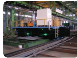
10-Pole Welding Machine (Bridge & Ship Construction) | 10-Pole 용접기 (교량 시공 & 조선)
